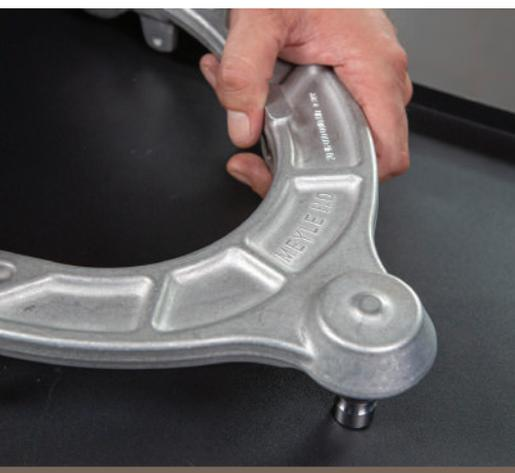
Im Aftermarket gibt es Anbieter, die originale Fahrwerkteile geändert haben. So auch bei bestimmten Tesla-Modellen, bei denen das Material des originalen Lenkers (siehe Bild oben) durch Aluminium ersetzt wird. Bilder: Meyle
