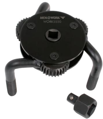
3-armig, 10 mm (3/8") Innenvierkant, mit Adapter 12,5 mm (1/2") Innenvierkant / 21 mm Außensechskant, passend für alle Pkw-Ölfilter Ø 70–120 mm.
