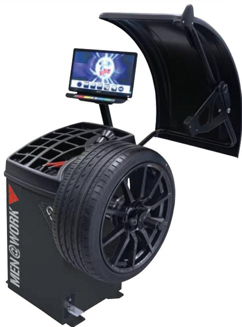
Automatischer Programmablauf und Datenübernahme von Felgendurchmesser, Abstand und Radbreite sowie automatische Datenübernahme im ALU-S und Pax-Programm. Einfache Bedienung durch 4-Farben-Tastatur. Ausgestattet mit Gewichteklemme und Pedalfeststellbremse für einfaches, exaktes Positionieren der Wuchtgewichte. Automatik-Stopp in Position des Wuchtgewichts. Darüber hinaus mit Sonderprogrammen wie Splitting (Hinterspeichenplatzierung), Matching und Gewichteminimierung.
