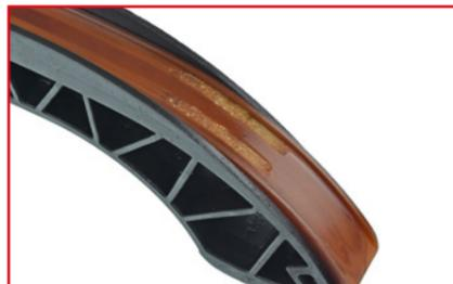
Führungsschienen werden durch den Verschleiß anderer Komponenten abgenutzt und schneiden Rillen in die Führungsfläche.
