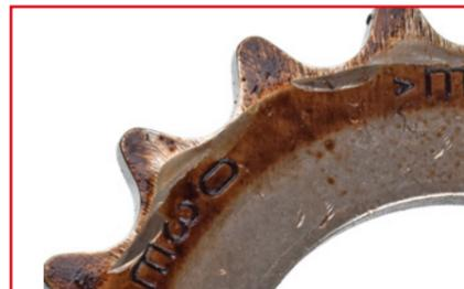
Kontaktbereich mit der Kette, Verschleiß an den Zähnen.
